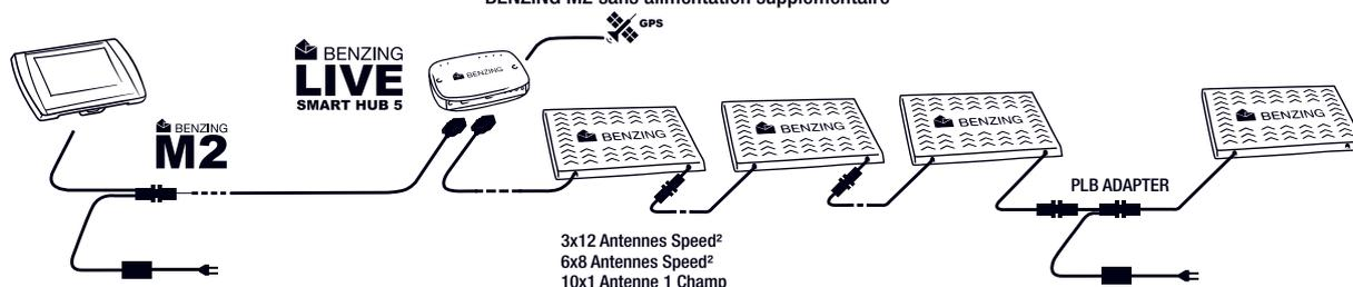
Le système peut être étendu à un maximum de 64 antenne SPEED<sup>2</sup> ou G2 à tout moment à l'aide de l'adaptateur d'alimentation PLB.
